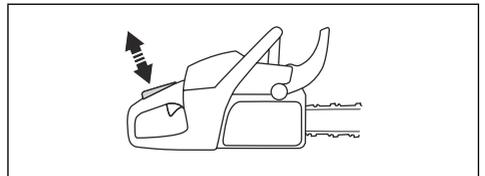
3. Stellen Sie sicher, dass der Gashebel in der Leerlaufstellung verriegelt ist, wenn die Gashebelsperre freigegeben wird.
