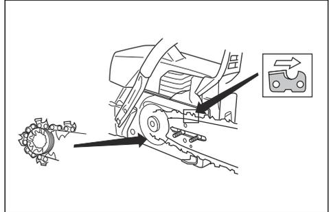
6. Richten Sie das Loch in der Führungsschiene an dem Stift der Ketteneinstellung aus, und befestigen Sie den Kupplungsdeckel.
