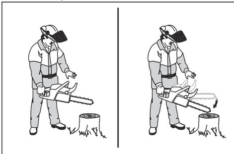
5. Stellen Sie sicher, dass die Kettenbremse aktiviert wird, sobald die Führungsschienenspitze auf dem Baumstumpf aufschlägt.
