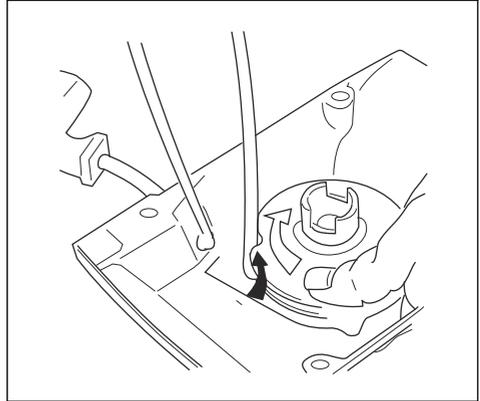
5. Entfernen Sie die mittlere Schraube und die Riemenscheibe.
