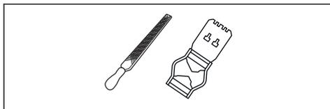
1. Nastavitev globine reza prilagodite s ploščato pilo in šablono za brušenje globinskih zob. Uporabljajte samo šablono za brušenje globinskih zob za nastavitev ustrezne globine in šablono za brušenje zelenih rezalnih zob družbe Husqvarna.
