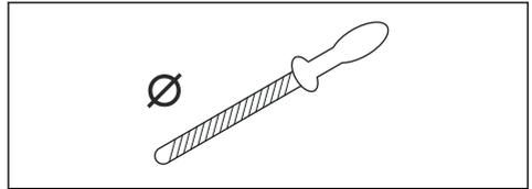
Ohne Hilfsmittel ist es nicht leicht, eine Sägekette korrekt zu schärfen. Verwenden Sie eine Husqvarna empfohlene Schärfelehre. Dies hilft Ihnen, die maximale Schneidleistung zu erhalten und die Rückschlaggefahr auf ein Minimum zu reduzieren.
