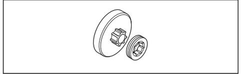
1. Stellen Sie sicher, dass kein Verschleiß am Rim-Antriebsrad vorliegt. Tauschen Sie es bei Bedarf aus.
