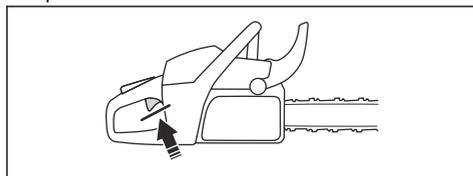
4. Zaženite izdelek in pritisnite polni plin.
