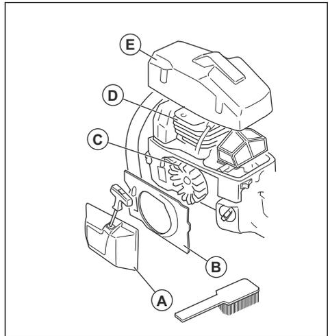
1. Reinigen Sie das Kühlsystem wöchentlich oder bei Bedarf häufiger mit einer Bürste.
