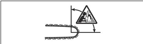
Ein Rückschlag ist immer in Richtung der Führungsschiene gerichtet. Normalerweise wird das Gerät gegen den Bediener geschleudert, manchmal aber auch in eine andere Richtung. Sie beeinflussen die Richtung der Bewegung durch Ihr Verhalten beim Auftreten des Rückschlags.
